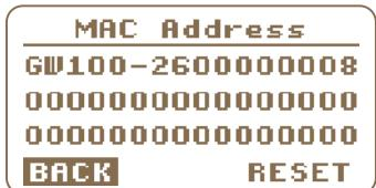
Volbou RESET můžete smazat z ohradníku všechny spárované gateway. Současně se tím změní MAC adresa ohradníku. To znamená, že gateway nebude umět vysílat a přijímat data z generátoru. Funkce slouží pro odebrání generátoru z gateway – např. při prodeji ohradníku, aby původní majitel nemohl ovládat přes cloud generátor nového majitele.
