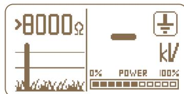
Pokud je na displeji generátoru u kontrolního uzemnění zobrazena pomlčka, tak to indikuje stav, na zelenou svorku není připojená kontrolní měřící elektroda nebo kdy není provedeno dostatečné zkratování vodiče ohrady (v případě impedance ohrady vyšší než 500 Ohm).
