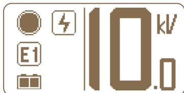
Na základní obrazovce se může objevit chybová hláška E1 – chyba vyhodnocení výstupního napětí. Tento stav indikuje, že ohradník nefunguje správně. Výkon generátoru je omezen na 5 J a nefunguje kontrolní měření uzemnění. Tento stav může být způsoben z mnoha různých důvodů. Proto v takovém případě je potřeba poslat generátor na naše Servisní oddělení k odbornému zkонтrolování a opravě.
