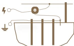
Přepětí způsobená bouřkou mohou poškodit izolaci elektrických ohradníků. V takovém případě se může síťové napětí dostat do elektrického ohradníku a může dojít k vážnému ohrožení lidí nebo zvířat.
